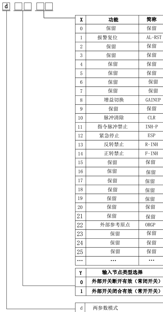
图 8.1.1 可编程输入端子功能设定示意图
