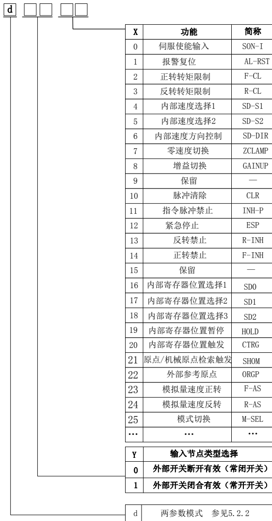
图 8.1.1 可编程输入端子功能设定示意图
