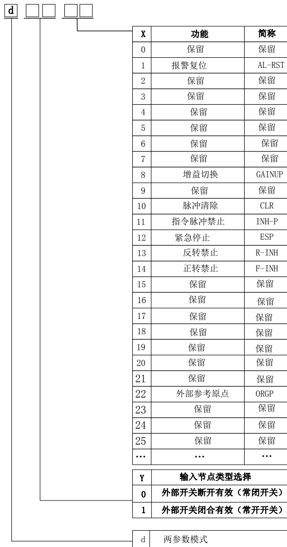
图 8.1.1 可编程输入端子功能设定示意图
