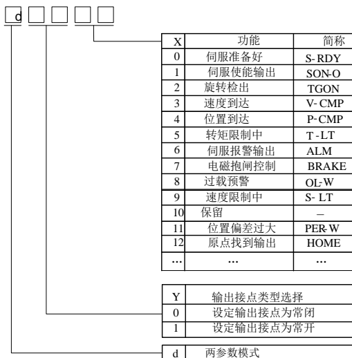
图 8.1.2 可编程输出端子功能设定示意图
