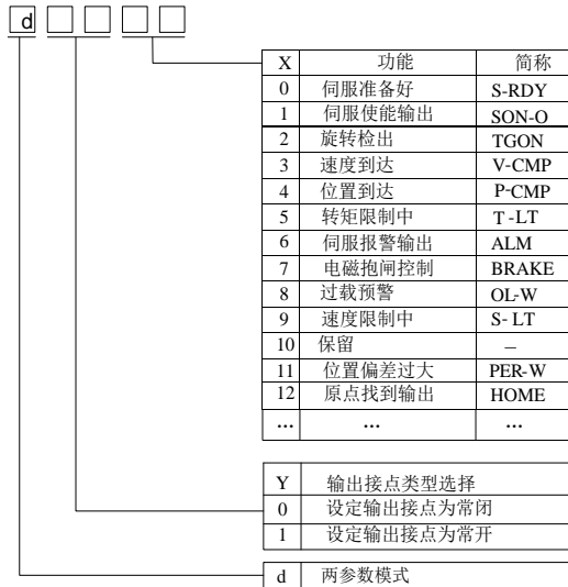
图 8.1.2 可编程输出端子功能设定示意图
